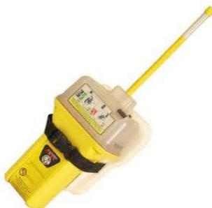
Il s'agit de la plus petite balise EPIRB (Emergency Position Indicating Radio Beacon) homologuée au monde. Cette balise Cospas-Sarsat est propre au bateau Give Me Five. La balise est un transmetteur qui émet un signal dans la bande de fréquence 406 MHz en numérique en cas de détresse, d'urgence, pour donner l'emplacement du bateau. Ce signal est ensuite reçu par la constellation des satellites du réseau Cospas-Sarsat, qui
